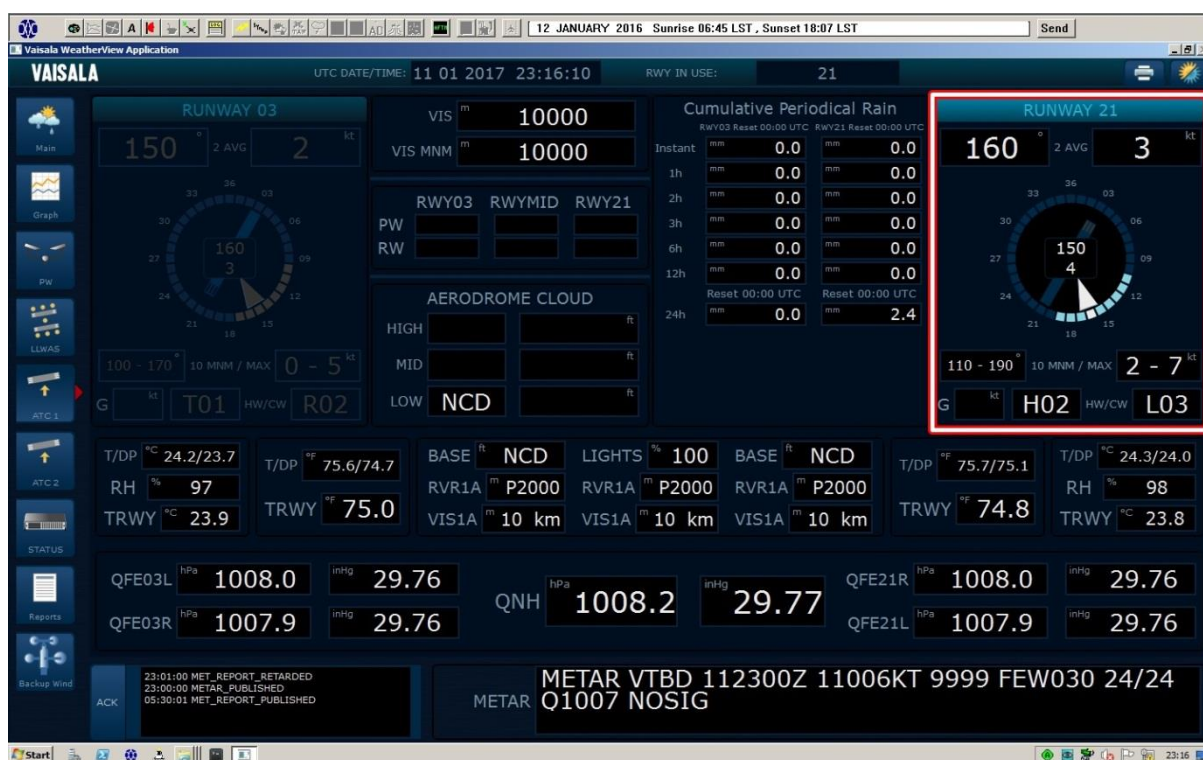
รูปที่ 1 ข้อมูลทิศทางและความเร็วลมจากหน้าจอ ATC1
