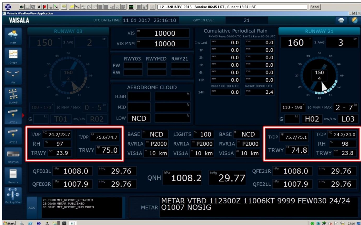
รูปที่ 17 ค่าอุณหภูมิที่แสดงอยู่ในหน้าจอ ATC1
