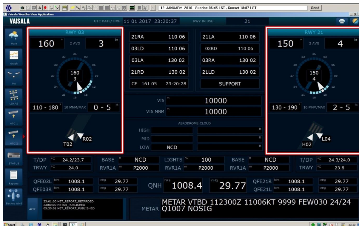
รูปที่ 2 ข้อมูลทิศทางและความเร็วลมจากหน้าจอ ATC2
